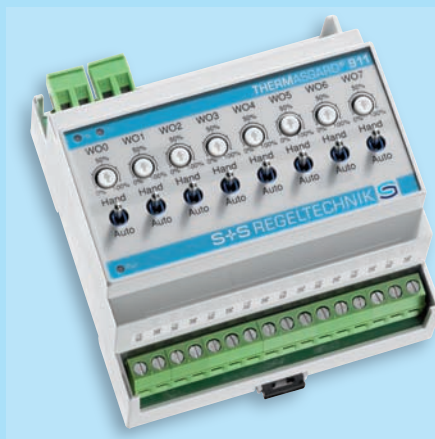
THERMASGARD® 9112 с 8 аналоговыми выходами (0-10 В), ручным управлением и резервным аварийным управлением
